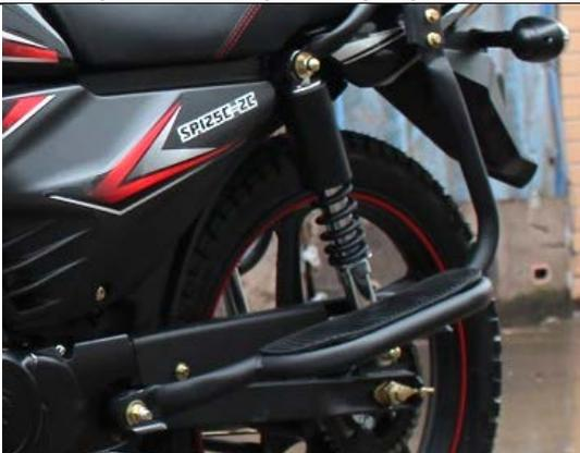
**Задняя подножка платформенного типа с антифрикционной накладкой, амортизаторы с защитным стаканом, защита ног пассажира.**
