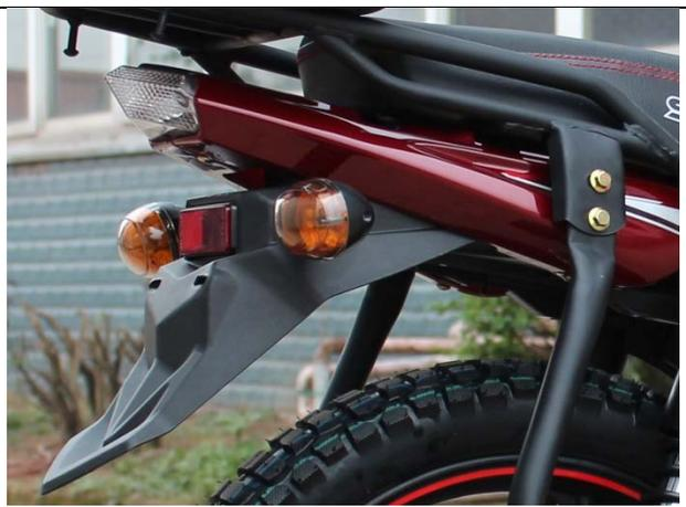
Современный задний фонарь спортивного вида встроен в заднее крыло. Большой задний катафот-светоотражатель. Пластиковое заднее крыло.
