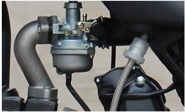
**Дополнительный сменный топливный фильтр.**
