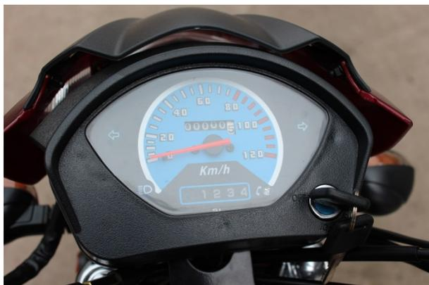
Спидометр/одометр, ближний/дальний, повороты, номер включенной передачи, индикатор входящего звонка.
