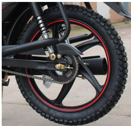
Защитный щиток на цепной передаче.
